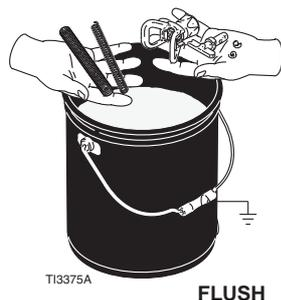
5. Placez l'ensemble du tube plongeur dans un seau métallique relié à la terre partiellement rempli de fluide de rinçage. Raccordez le câble de mise à la terre à une vraie prise de terre. Exécutez les étapes de démarrage 1 à 6 (consultez la page 9) afin de rincer la peinture du pulvérisateur. Utilisez de l'eau pour rincer une peinture à base d'eau et du white spirit (ou un solvant équivalent) pour rincer une peinture à base d'huile.
