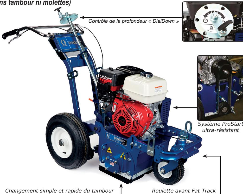
La GrindLazer HP DC1013 G est un rabot routier d'entrée de gamme idéal pour effacer les lignes de parkings et le marquage routier. Retrait de peinture de signalisation, produits thermoplastiques, lissage des surfaces irrégulières.
